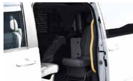
ドア開口部手すり
